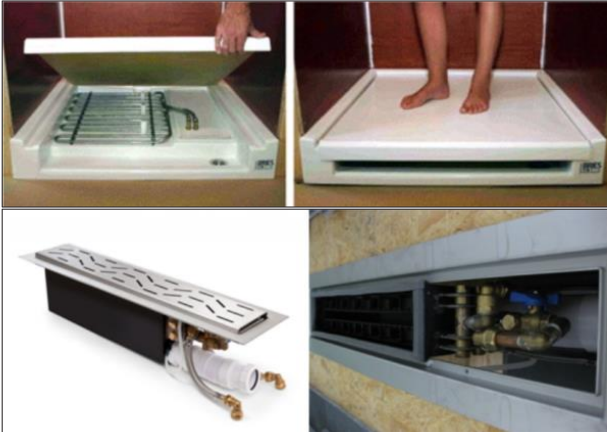
Figuur 2: Riothermie aan de bron: boven: warmtewisselaar geïntegreerd in een douchebak – onder: douchegootwarmtewisselaars
