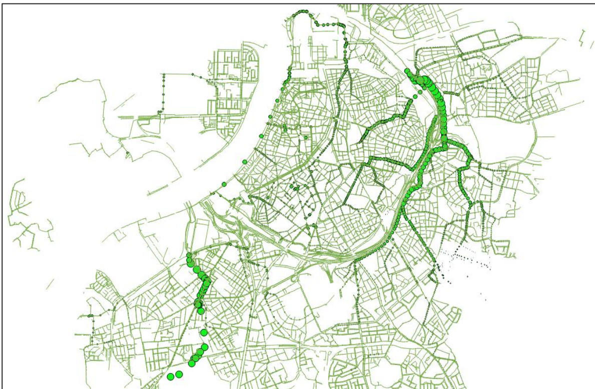
Figuur 27: Rioleringstelsel en DWA-debieten in het centrum van Antwerpen
